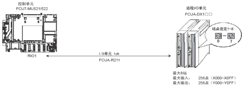
图 1-20 与数控单元直连时拨码旋钮的设置
