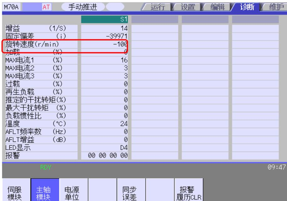
图 2-34 主轴电机转速确认
