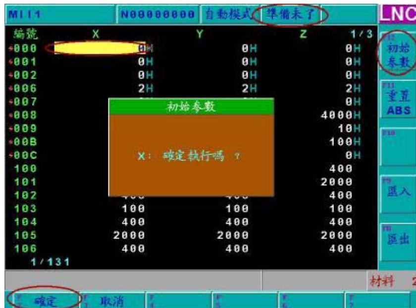
依序此步骤将所有的 M-II轴驱动器初始化后，将控制器电源与驱动器重电切断再重开即可。
